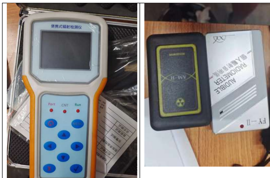
图 3-7 本项目配备辐射监测仪器
