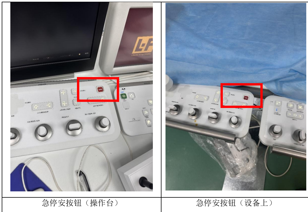
图3-4 DSA机房控制室及机房内的急停按钮
