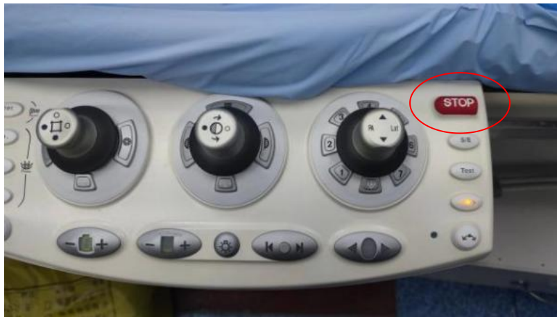
图3-6 DSA机房控制室及机房内的急停按钮
