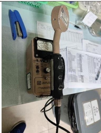
主院区辐射巡检仪
