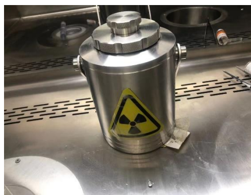
铅转运防护罐
