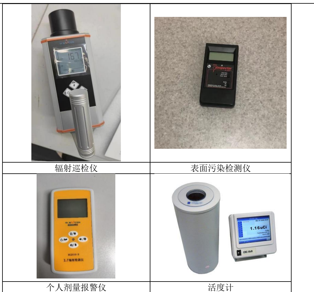
图 3-9 本项目配备辐射剂量检测仪器
