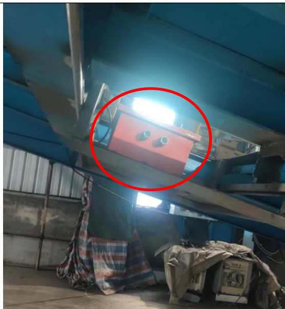
图2-1 KJ1040型X射线探伤设备
