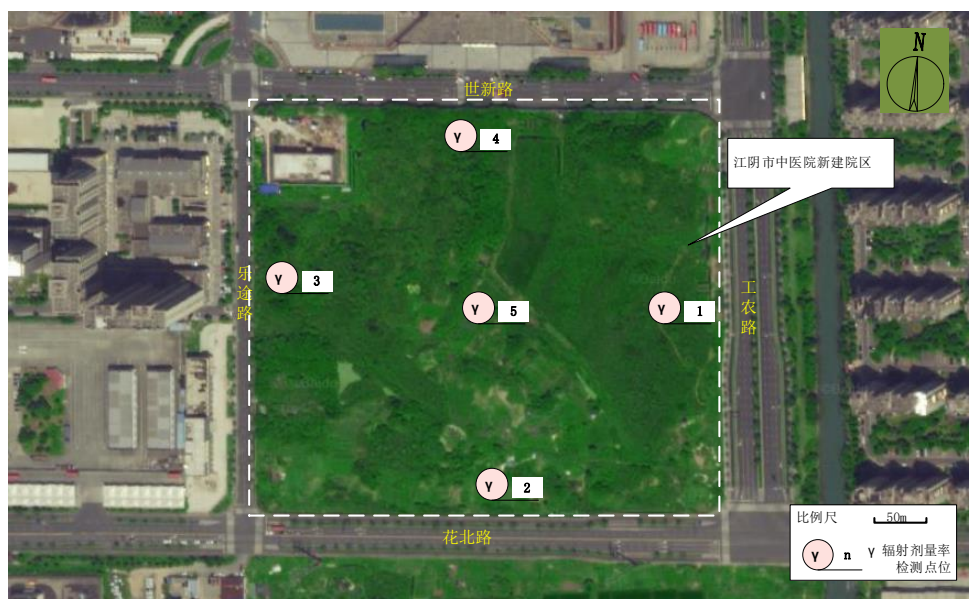
图 8-5 江阴市中医院新建放射诊疗项目拟建址周围环境 \gamma 辐射监测点位示意图
