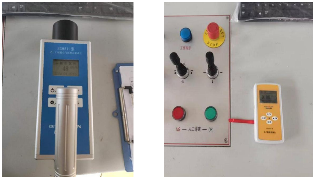
图3-8 本项目配备辐射巡测仪和个人剂量报警仪
