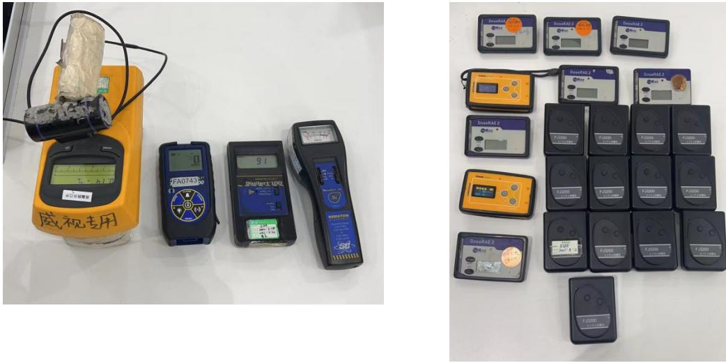
图3-6 本项目配备辐射巡测仪和个人剂量报警仪
