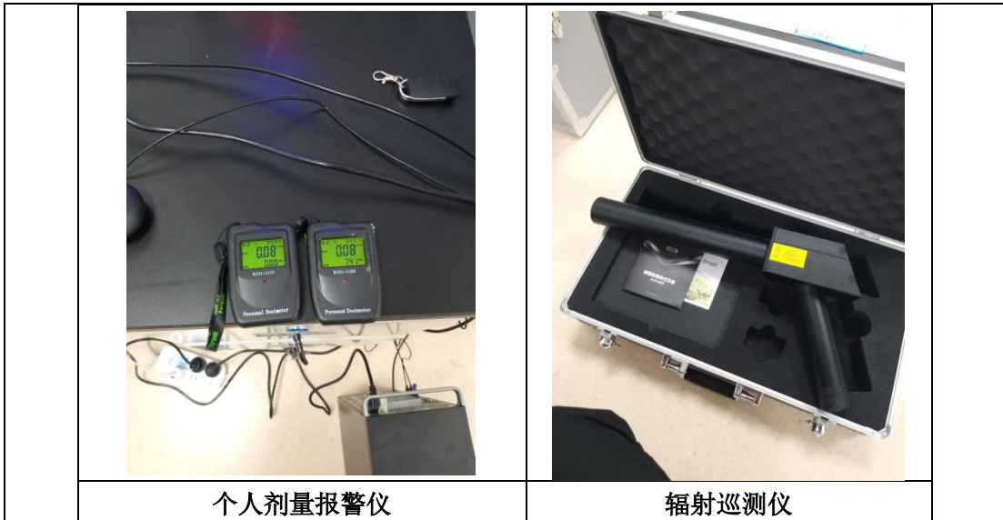
图 3-13 本项目配备辐射剂量检测仪器
