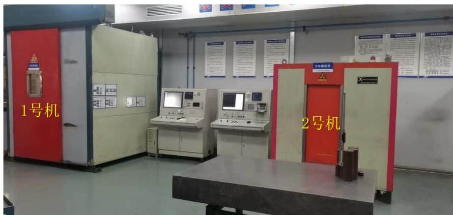
图2-1 本项目X射线实时成像检测装置外观
