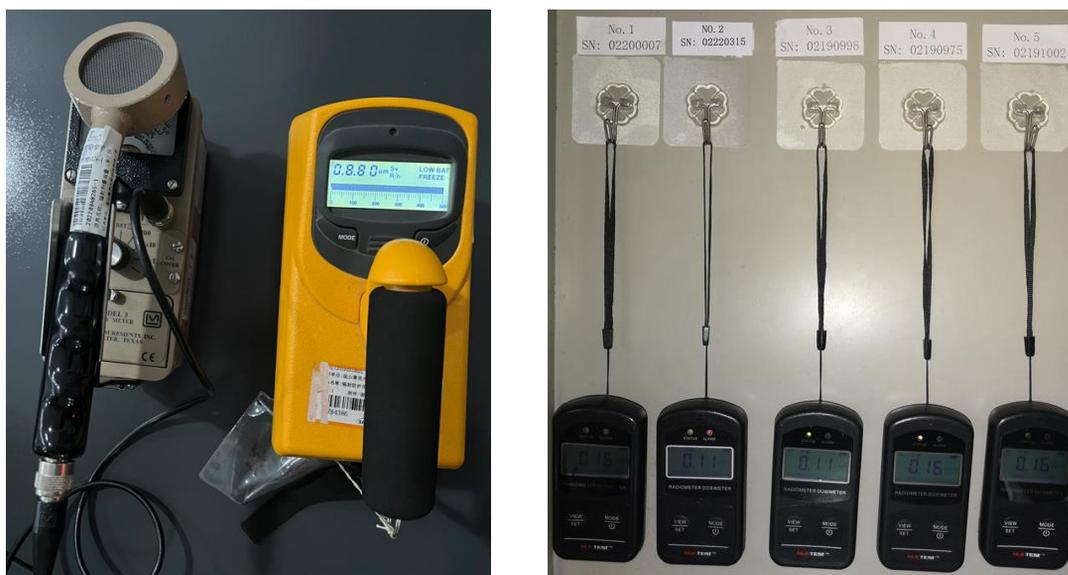
图3-5 本项目配备辐射巡测仪和个人剂量报警仪
