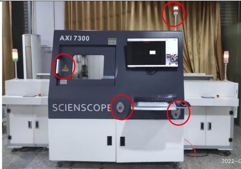
图3-4 工业X射线探伤装置电离辐射警告标志、工作状态指示灯、急停按钮和钥匙开关
