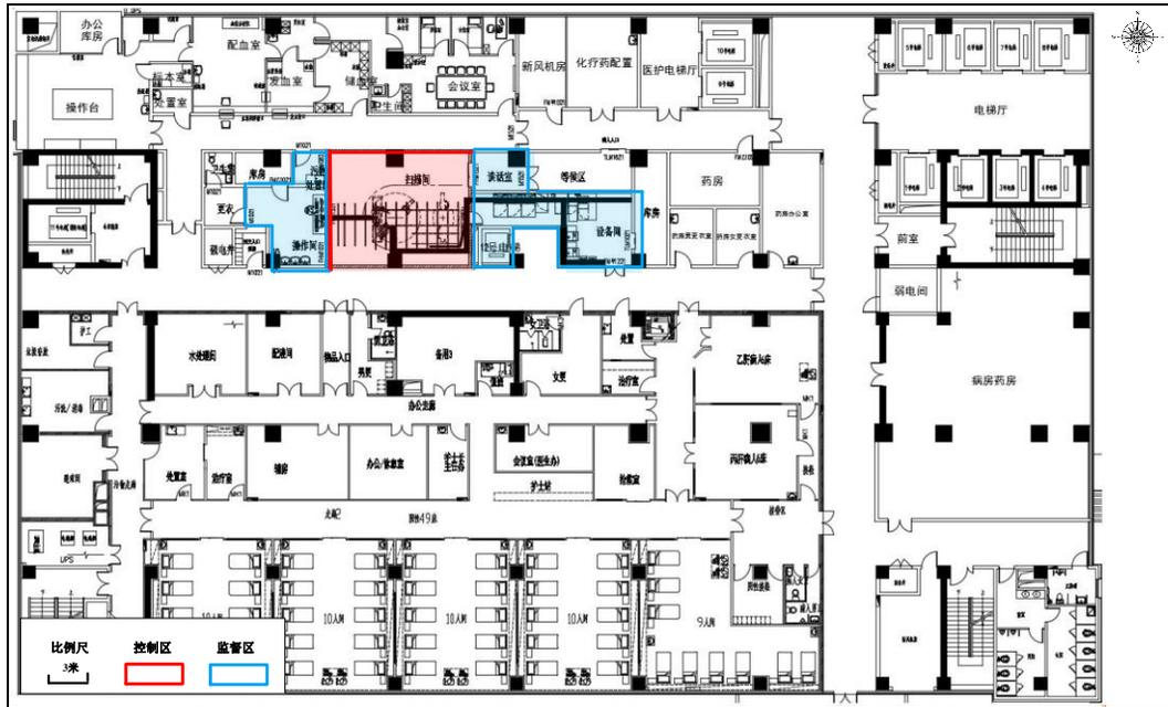
图3-1 住院综合大楼2层DSA机房平面布置及分区示意图
