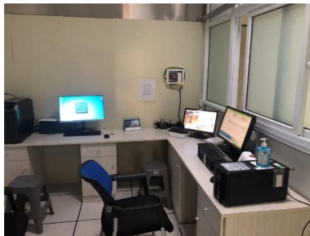
后装控制室固定式剂量报警仪
