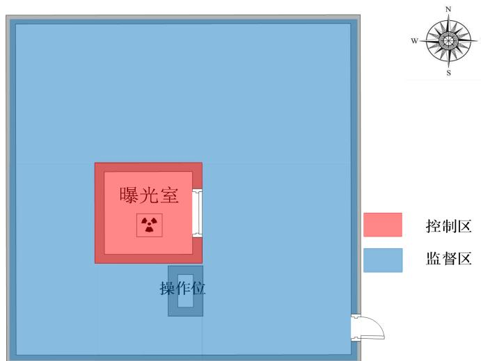
图 4-1 本项目辐射防护分区示意图
