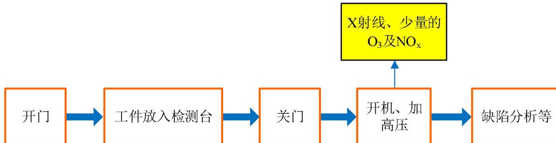
图 3-3 本项目 X 射线检测装备工作流程与产污环节分析
