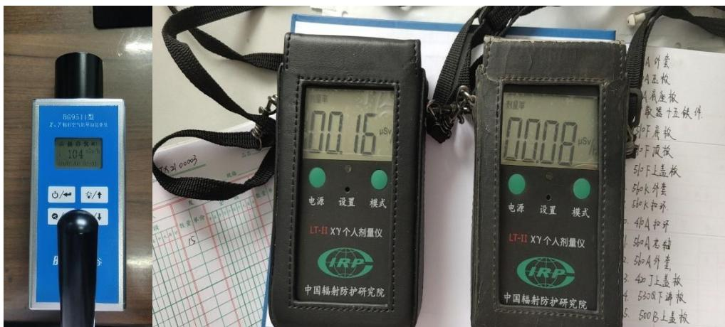
图 4-4 辐射巡测仪及个人剂量报警仪
