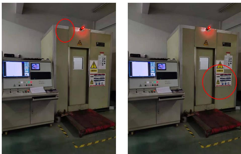
图 4-2 X 射线实时成像检测系统电离辐射警告标志及工作状态指示灯
