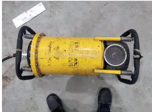
图3-4 本项目固定式X射线探伤机操作位外观图
