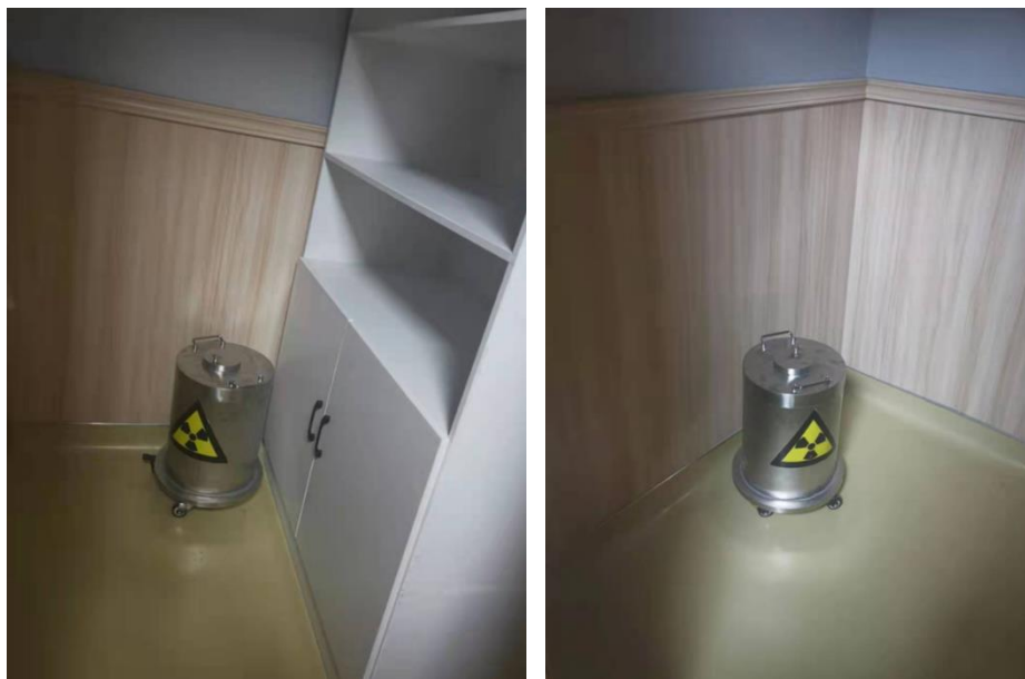
图 4-14 废物库和储源室铅防护容器
