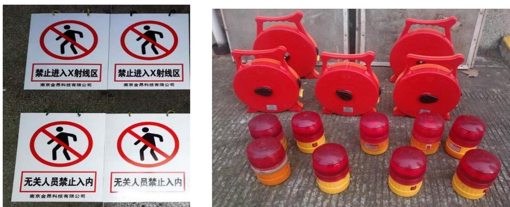
图 4-2 控制区、监督区警告牌及声光报警装置
